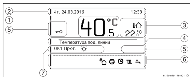
Рис. 2 Пример стандартной индикации в системе с несколькими контурами отопления/охлаждения
