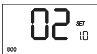
Рис. 18. Настройка отопительной кривой.
