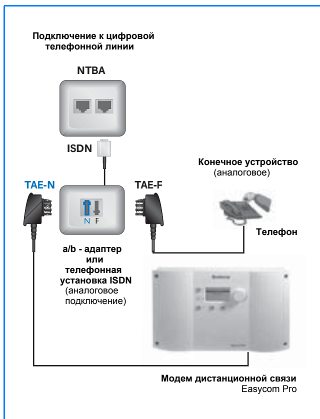
52/2 Подключение модема дистанционной связи Easycot или Easycot PRO к сети ISDN через адаптер a/b или через телефонную установку ISDN. Каждый параллельный аппарат имеет свой собственный номер дозвона (MSN).
